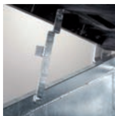
Blokada pokrywy w pozycji otwartej
