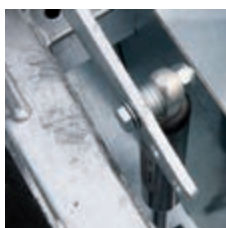
Verriegelung des Deckels in offener Lage – Dämpfer
